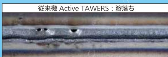
【MAG, 高張力鋼(980 MPa)板厚0.8 mm, 150 A, 100 cm/分, ギャップ1 mm, 重ね継手】
