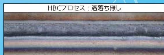
【MAG, 高張力鋼(980 MPa)板厚0.8 mm, 150 A, 100 cm/分, ギャップ1 mm, 重ね継手】
