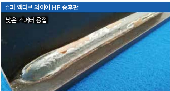
하향 스퍼터 SPHC(9.0 mm) 320 A/40 cm/min YM-50(φ1.2)CO2
