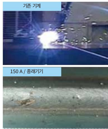
피팅 : 스테인리스강 SPCC(판 두께 : 2.3 mm) 용접 전류 : 150 A 용접 속도 : 50 cm/min 와이어 : φ1.2(YM-50MT) 가스 : MAG(Ar:80%, CO2:20%)
